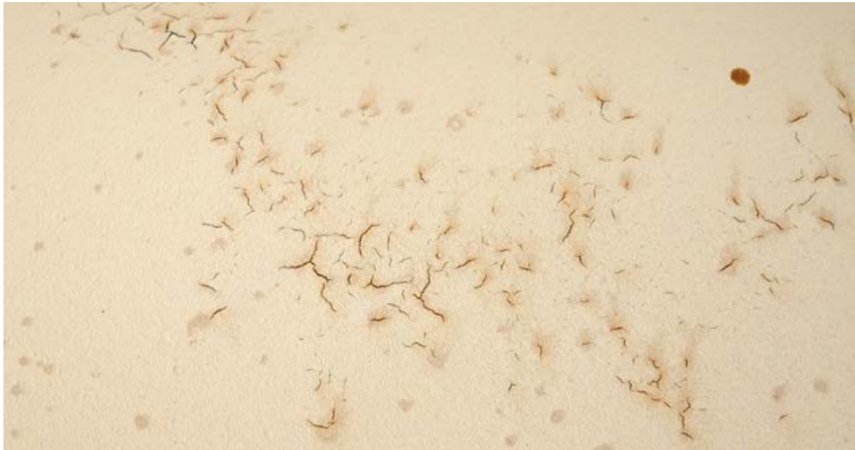
Abbildung 9: Korrosion auf dem Substrat
